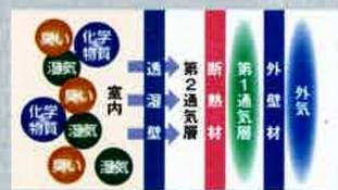
通気断熱WB工法のイメージ図。透湿性のある壁材と通気層で皮膚のように呼吸
