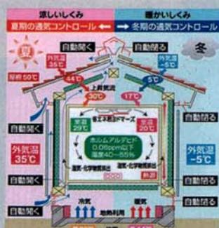
通気断熱WB工法のイメージ図。透湿性のある壁材と通気層で皮膚のように呼吸
